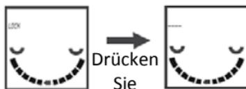
Sobald die erste Zahl links blinkt, drücken Sie die Taste B und die erste Zahl wird sequenziell angezeigt: 0, 1, 2, 3, 4, 5, 6, 7, 8, 9. Drücken Sie die Taste A, um die Zahl zu bestätigen, die unterstrichene der nächsten Zahl blinkt: wiederholen Sie den gleichen Vorgang, bis Sie 4 Zahlen gewählt haben. Zu Ende der Eingabe wird der Code automatisch überprüft.
